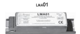
Адресуемый модуль для работы с системой центральной батареи «POWERTECH», с мониторингом светильников 0,5-150 вА. Адрес и функцию модуля следует выбрать согласно спецификации объекта. Соответствует требованиям vde 0108. Для применения в светильниках, предназначенных для работы в рабочем или только аварийном режиме.
