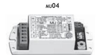
Адресуемый модуль, встроенный в балласт для флуоресцентных ламп 4-13 Вт (T5-4, 6, 8 Вт, Compact 5, 7, 9, 11, 13 Вт). Адрес и функцию модуля следует выбрать согласно спецификации объекта. Соответствует требованиям vde 0108. Для применения в светильниках, предназначенных для работы в рабочем, только аварийном или смешанном режиме. В случае светодиодов LED следует применять модель MLED300.
